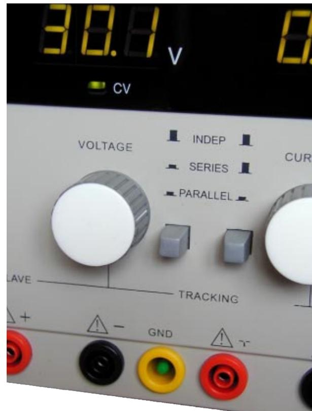
Certains modèles utilisés en série ou parallèle, vous permettent de doubler la tension ou l'intensité.
