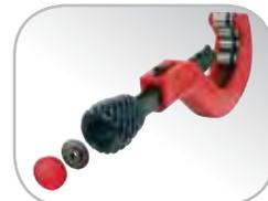
Coupe-tubes plastiques à avance rapide - Pour PE, PP, PB, PUDF, PVC et tuyaux composites - Coupe-tubes à avance et recul rapide. Ébavureur intégré et articulé et molette de recharge dans la poignée - Maximum PN 25 ép. parois ≤ 5 mm - Les coupe-tubes conviennent pour le cuivre en remplaçant les molettes
