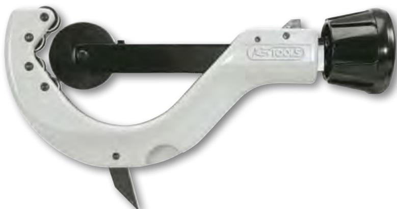
Pour PE, PP, PB, PUDF, PVC et tuyaux composites - Coupe-tubes à avance et recul rapide - Ébavureur intégré et articulé et molette de recharge dans la poignée - Maximum PN 25 ép. parois ≤ 19 mm - Les coupe-tubes conviennent pour le cuivre en remplaçant les molettes
