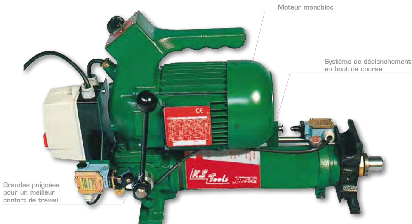
Permet le réglage d'un angle fixe avec le déclenchement et arrêt automatique du vérin en bout de course.
