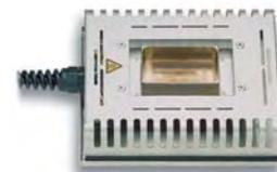
Le bain de soudure WSB 150 est idéal pour l'étamage et la préparation des composants à souder. Il a une température régulée de 50° – 550°C connecté sur un bloc de régulation 150 W et est un complément appréciable de la station WSD 151. En option, un plateau métal permet de recueillir les gouttes de soudure résiduelles. Compatible avec la soudure sans plomb.
