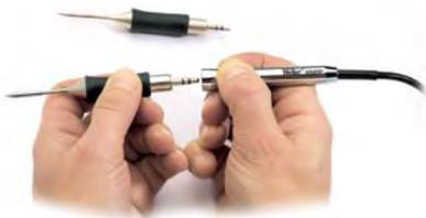
Les pannes de fer à souder série RT sont spécialement conçues pour les travaux de micro brasure sous binoculaire et peuvent, bien entendu, aussi être utilisées avec du métal d'apport sans plomb.
