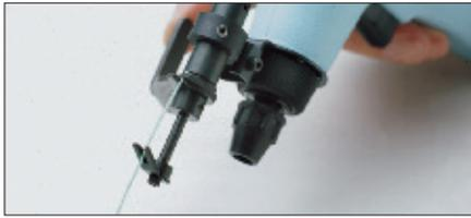
Suivant la broche, le fil est dénudé pendant le wrapping ou avant grâce à un outil de dénudage
