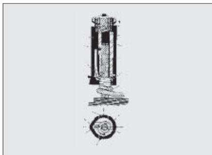
Technique de la connexion enroulée „Wire-Wrap“
