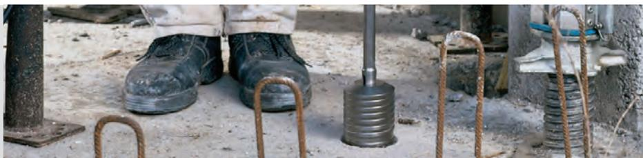
Les trépan carbure MAKITA bénéficient d'un traitement thermique de haute qualité. Ils sont robustes et dotés d'un nombre important de dents en carbure pour une progression rapide de perçage.
