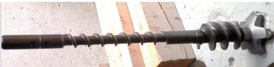
Les forets modulaires sont particulièrement adaptés aux situations de perçage difficile. Ils sont robustes et développent une progression de perçage rapide grâce à leurs nombreuses dents en carbure.
