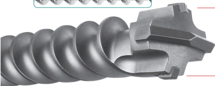
L'hélice spéciale KVS-SPIRALE assure par sa conception en double spirale, une évacuation maximale des poussières. Sa structure renforcée et le traitement spécial de la surface augmentent la longévité et le rendement du foret.
