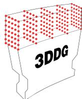
La technologie 3DDG consiste en l'alignement des grains de diamant en 3 dimensions. Les grains sont disposés de façon contrôlée et uniforme dans le segment.
