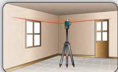
Mise à niveau d'éléments (portes, fenêtres, ...)
