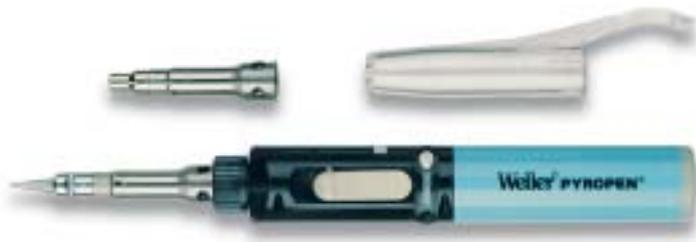
Fer à souder fonctionnant au butane, à auto-allumage, fonctions de soudure et d'air chaud. Température variable jusqu'à 500°C. D'une montée en température rapide, il est doté d'une autonomie d'environ 1 heure. Fourni avec un capuchon de protection avec dispositif de sécurité pour éteindre le fer.
