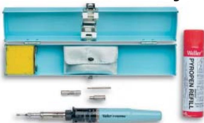
Un fer à souder au butane à allumage manuel avec fonctions de soudure, d'air chaud et de chalumeau. Montant en température rapidement, l'outil est doté d'une autonomie d'environ 3 heures. Température variable entre 350°C et 500°C en mode fer à souder et jusqu'à 650°C en mode d'air chaud et 1300°C en mode chalumeau.
