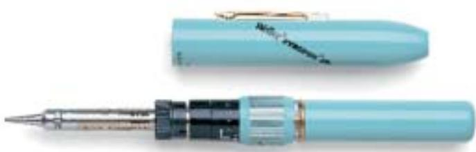
Un fer petit à souder à allumage manuel fonctionnant au butane avec fonctions de soudure, d'air chaud et de chalumeau. Fourni avec capuchon de protection en aluminium avec clip de poche et dispositif de sécurité empêchant la pose du capuchon lorsque le fer est allumé. Température variable entre 400°C et 500°C en mode fer à souder et jusqu'à 650°C en mode de soufflage d'air chaud et 1300°C en mode chalumeau. Équipé d'une panne en aiguille de 0,5 mm.
