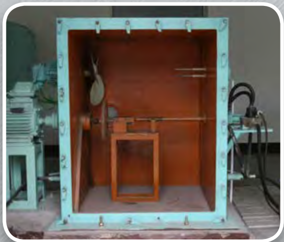
Test à la friction en milieu explosif
