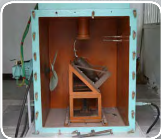
Test de déflagration au choc en milieu explosif
