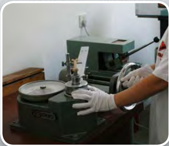
Contrôle dynamométrique et de résistance à la rupture
